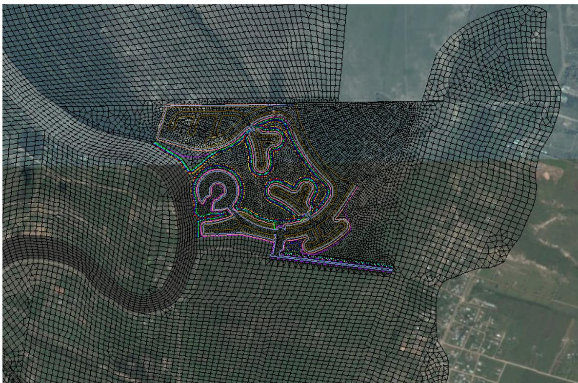
Figura 4-1: Vista general y en detalle de la Malla de elementos finitos del modelo Hidrodinámico bidimensional.
