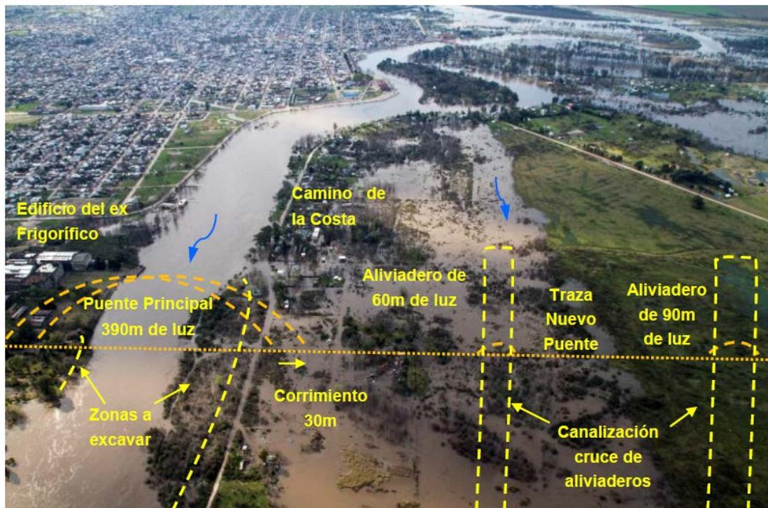
Figura 3-9: Esquema final de diseño hidráulico para la implantación del Nuevo Puente
